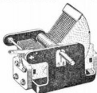
WAGBBII Drehkondensator mit
