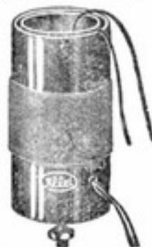
C) Oszillatorspule 40 K, für die normale Schaltung m. 150 cm Abstimmndrehkondens. Brutto 1,70
